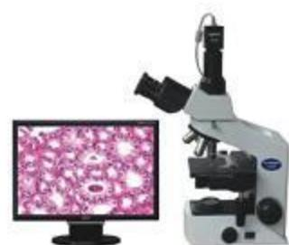
ME21采用奥林巴斯CX2显微镜主机, 具有UIS2无限远光学系统, 平场消色差物镜, 数码摄像装置采用USB2.0接口, 图像传输速度快, 分辨率高, 色彩还原好, 配套采集处理软件使用操作方便, 功能强大, 同时系统扩展性能强, 可根据不同的需要选择相关附件, 达到明场、暗场、相衬等观察方式。ME21是生物医学研究与工农业检测的理想仪器。
