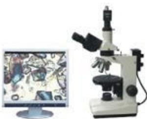
ME51配置专业偏光物镜，透射、反射光源，专业数码成像系统，以及石膏入、云母λ/4试片、石英楔子和移动尺等附件，具有单偏光、正交偏光、锥光及明视场观察与显微拍摄功能，其成像像质好，使用操作简单，可直接对偏光显微图片进行保存、编辑与打印，是一套功能完备品质良好的新型显微镜。
